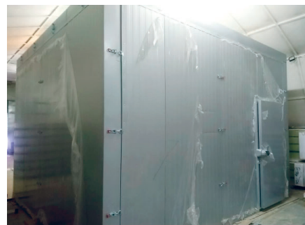
Предварительная сборка одной секции климатической камеры
