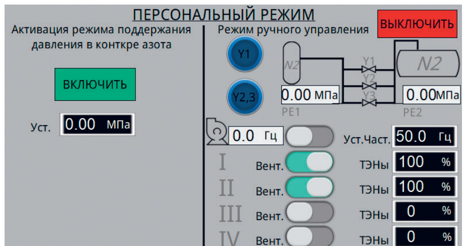
Экран ручного управления исполнительными механизмами климатической камеры
