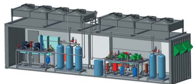
рис.2. Компрессорно-конденсаторная станция с двумя компрессорными агрегатами и ресиверными блоками
